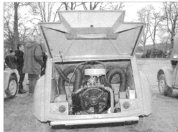
Une 2 CV 4x4 elle peut aussi rouler avec le seul moteur arrière.
